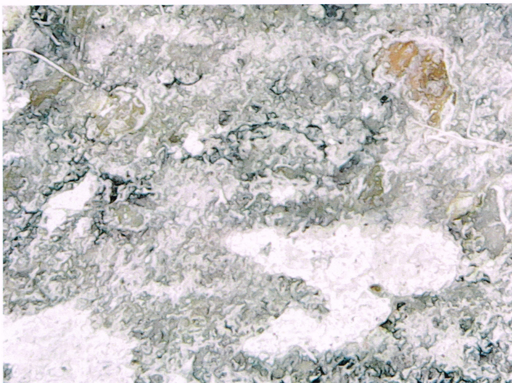
fot. 3: Zdjęcie mikroskopowe tynku w pasie czwartego piętra. Widoczne pozostałości szarej warstwy.
