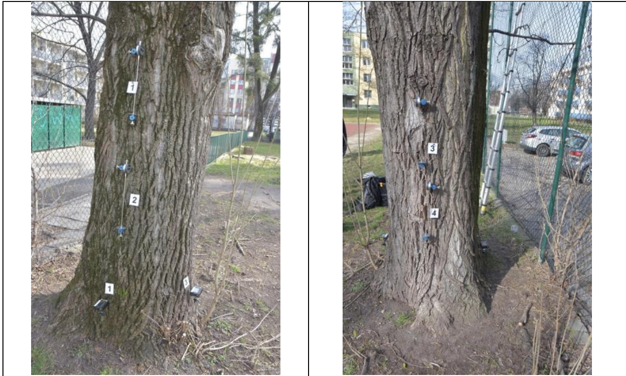
Fot. 5-5. Topola kanadyjska ID 8151, ul. Ciepła 15, Wrocław. Próba obciążeniowa - miejsce mocowania czujników - strona ściskana
