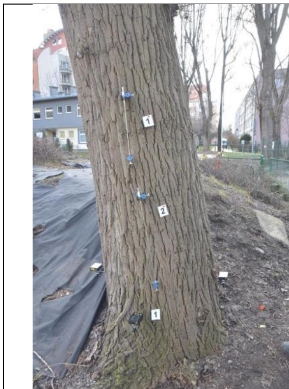
Fot. 2-5. Topola kanadyjska ID 8147, ul. Ciepła 15, Wrocław. Próba obciążeniowa - miejsce mocowania czujników - strona ściskana
