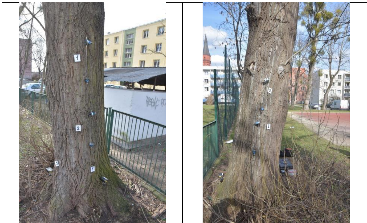
Fot. 1-5. Topola kanadyjska ID 8143, ul. Ciepła 15, Wrocław. Próba obciążeniowa - miejsce mocowania czujników - strona ściskana
