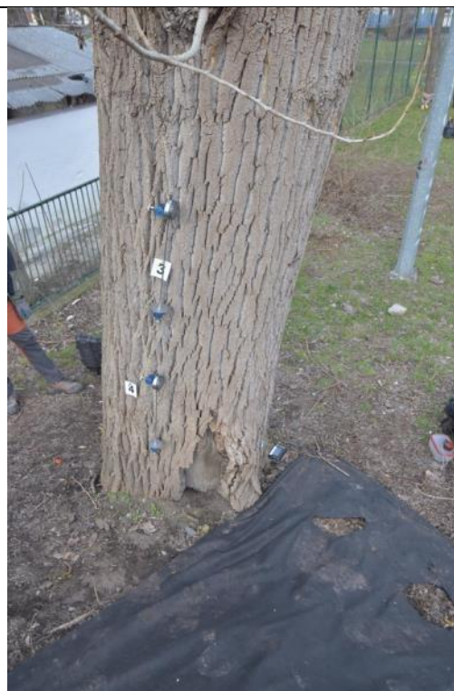
Fot. 2-6. Topola kanadyjska ID 147, ul. Ciepła 15. Próba obciążeniowa - miejsce mocowania czujników – strona rozciągana
