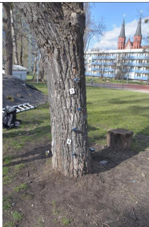
Fot. 15-6. Topola kanadyjska ID 8167, ul. Ciepła 15. Próba obciążeniowa - miejsce mocowania czujników – strona rozciągana
