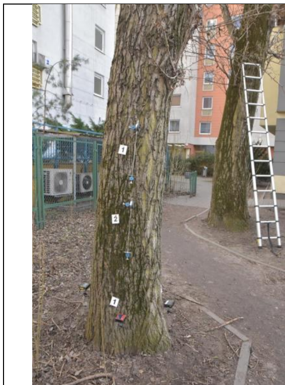
Fot. 13-5. Topola kanadyjska ID 8165, ul. Ciepła 15, Wrocław. Próba obciążeniowa - miejsce mocowania czujników - strona ściskana
