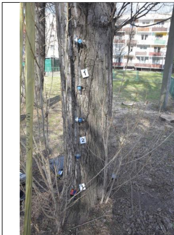
Fot. 7-5. Topola kanadyjska ID 8158, ul. Ciepła 15, Wrocław. Próba obciążeniowa - miejsce mocowania czujników - strona ściskana
