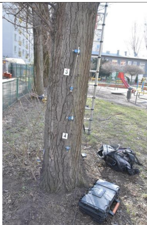
Fot. 7-6. Topola kanadyjska ID 8158, ul. Ciepła 15. Próba obciążeniowa - miejsce mocowania czujników – strona rozciągana
