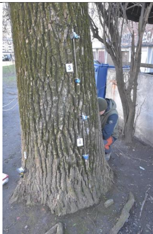
Fot. 16-6. Topola kanadyjska ID 8169, ul. Ciepła 15. Próba obciążeniowa - miejsce mocowania czujników – strona rozciągana
