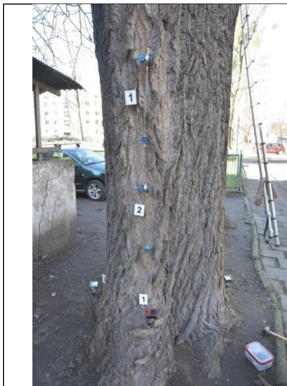
Fot. 16-5. Topola kanadyjska ID 8169, ul. Ciepła 15, Wrocław. Próba obciążeniowa - miejsce mocowania czujników - strona ściskana
