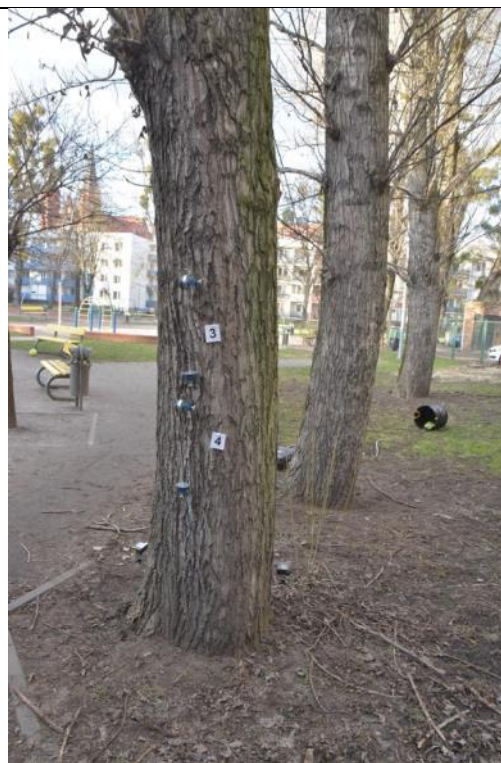
Fot. 13-6. Topola kanadyjska ID 8165 ul. Ciepła 15. Próba obciążeniowa - miejsce mocowania czujników – strona rozciągana
