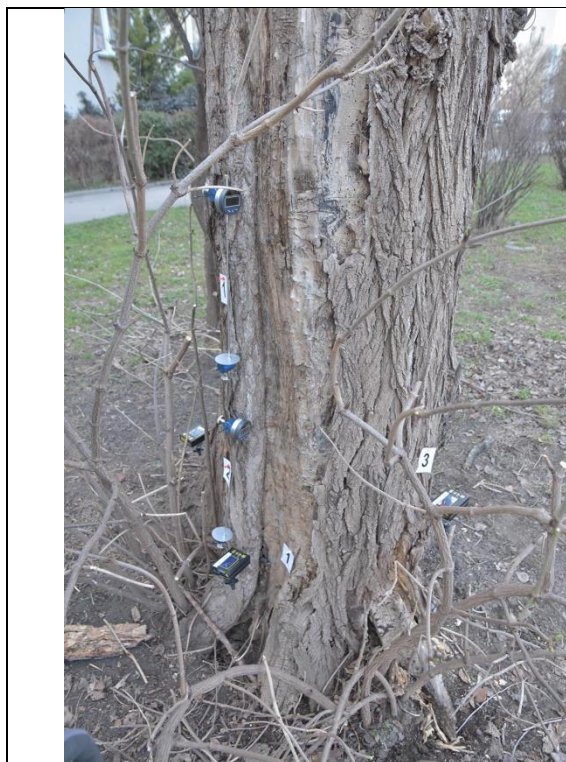
Fot. 6-9. Topola włoska ID 13881, ul. Hubska 41-53, Wrocław. Próba obciążeniowa - miejsce mocowania czujników - strona ściskana
