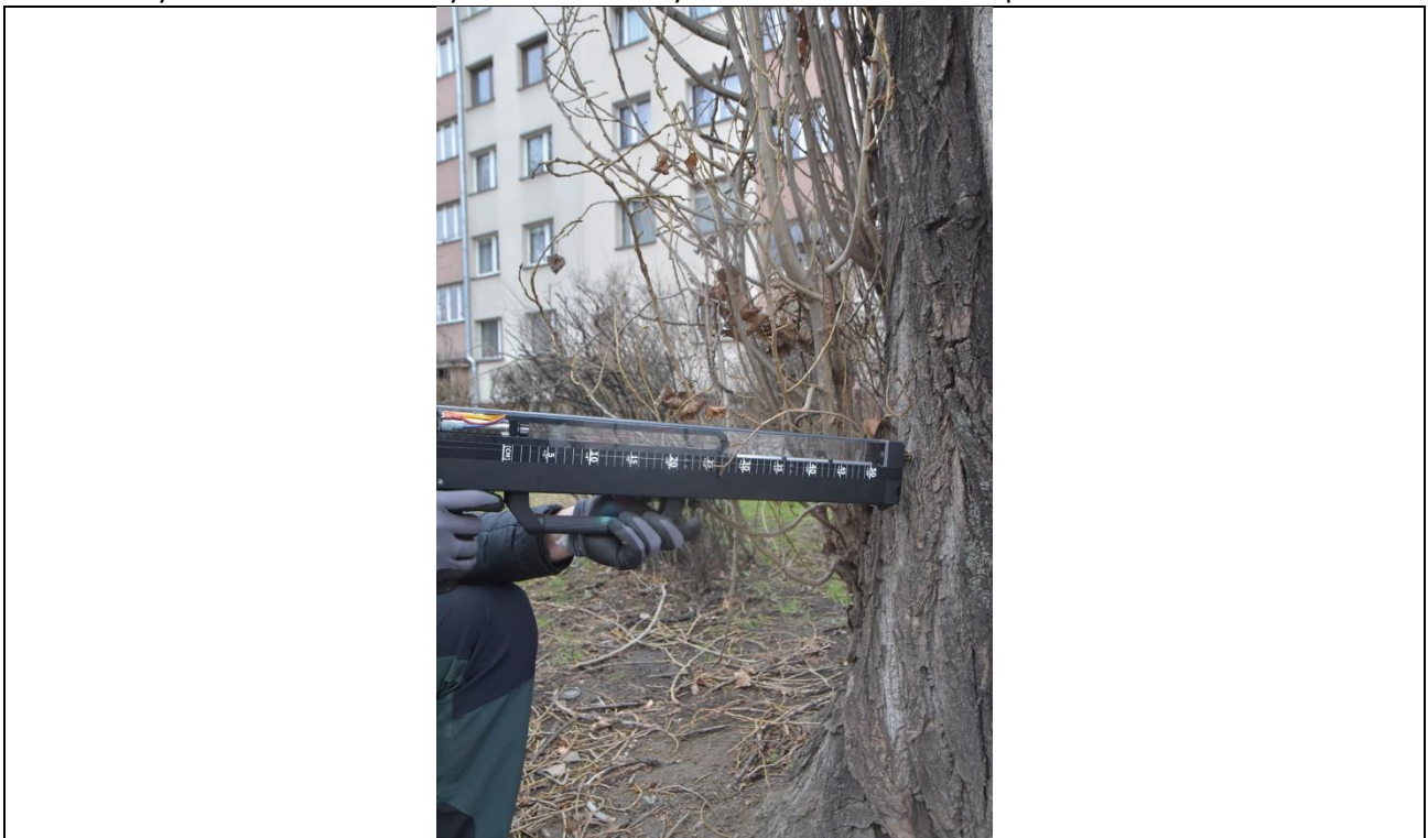
Fot. 10-7 Topola włoska ID 13889, ul. Hubska 41-53, Wrocław. W trakcie badania rezystografem
