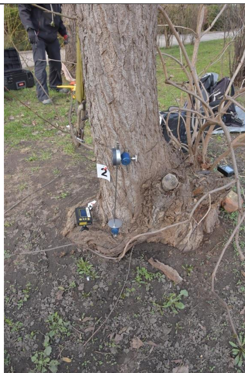
Fot. 5-7. Topola ID 13878, ul. Hubska 41-53, Wrocław. Próba obciążeniowa - miejsce mocowania czujników – strona rozciągana
