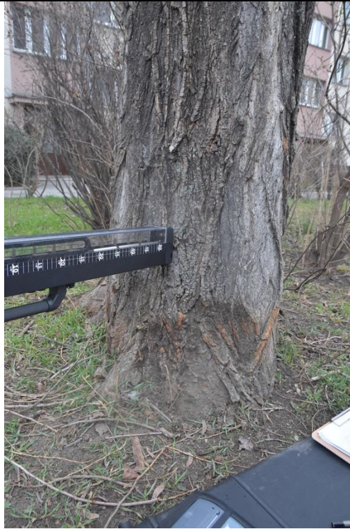
Fot. 8-5. Topola włoska ID 8143, ul. Hubska 41-53, Wrocław. W trakcie badania rezystografem
