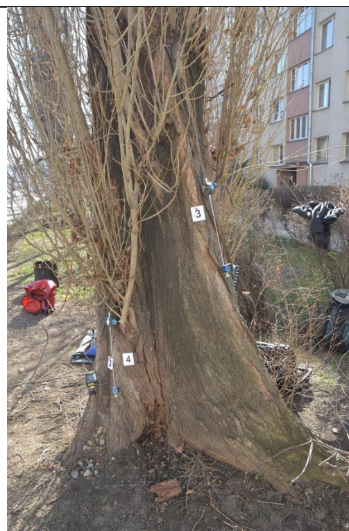
Fot. 10-9. Topola włoska ID 13889, ul. Hubska 41-53, Wrocław. Próba obciążeniowa - miejsce mocowania czujników – strona rozciągana
