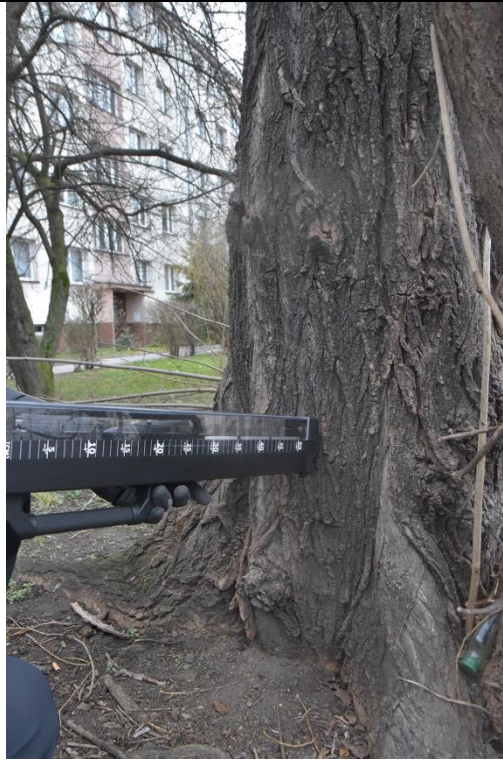
Fot. 2-5. Topola włoska ID 13871, ul. Hubska 41-53, Wrocław. Podczas badania rezystografem.
