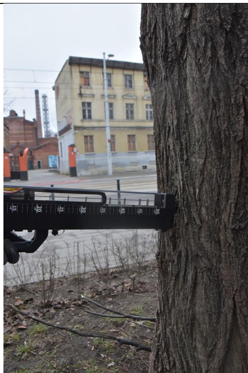
Fot. 3-7, 3-8. Topola włoska ID 13872, ul. Hubska 41-53, Wrocław.. Podczas badania rezystografem.
