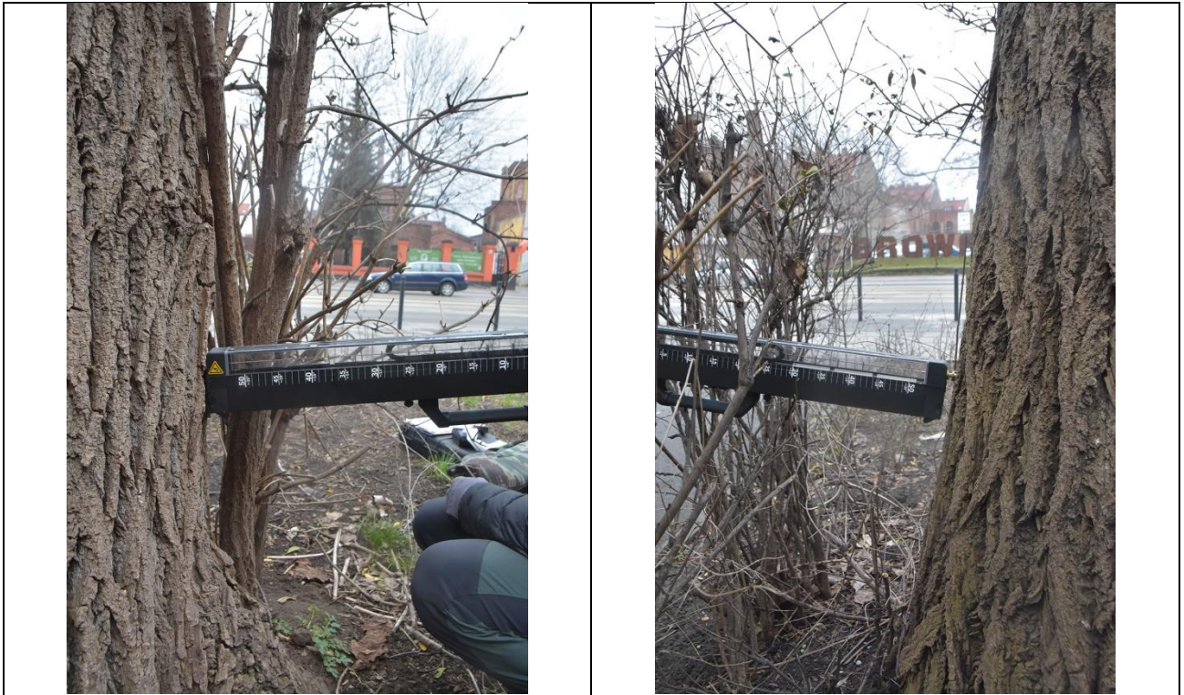
Fot 4-5 i 4-6. Topola kanadyjska ID 13876, ul. Hubska 41-53, Wrocław.. Podczas badania rezystografem
