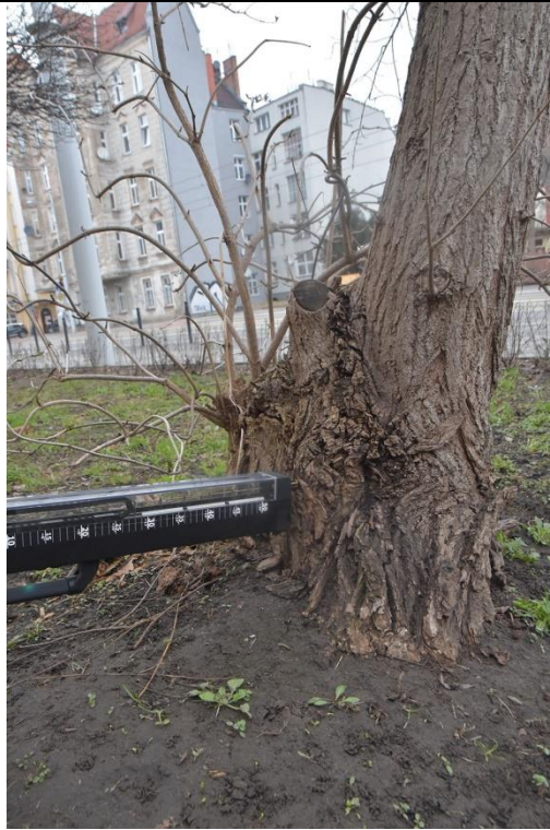
Rys. 5-5. Topola ID 13878, ul. Hubska 41-53, Wrocław. Podczas badania rezystografem.
