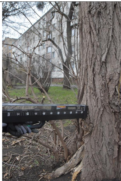
Fot 6-7 i 6-8. Topola włoska ID 8143, ul. Hubska 41-53, Wrocław. Podczas badania rezystografem
