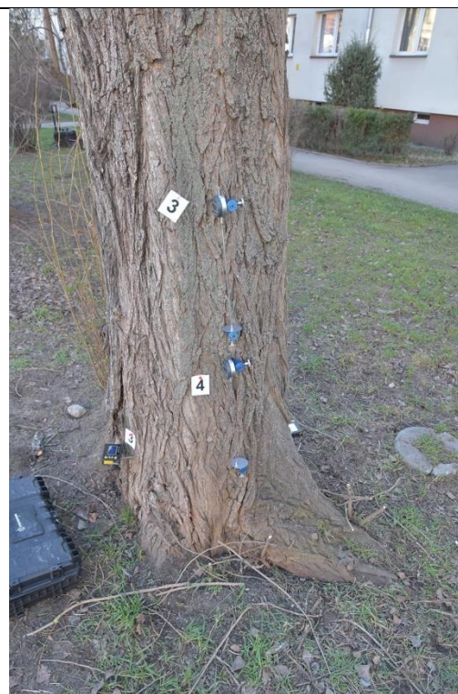
Fot. 7-9. Topola włoska ID 13883, ul. Hubska 41-53, Wrocław. Próba obciążeniowa - miejsce mocowania czujników – strona rozciągana
