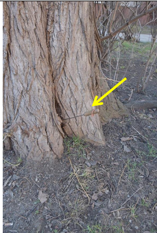
Fot. 9-2. Topola włoska ID 13885 ul. Hubska 41-53, Wrocław. Dolna część pnia. Między nabiegami rozkład drewna stwierdzony sondą.
