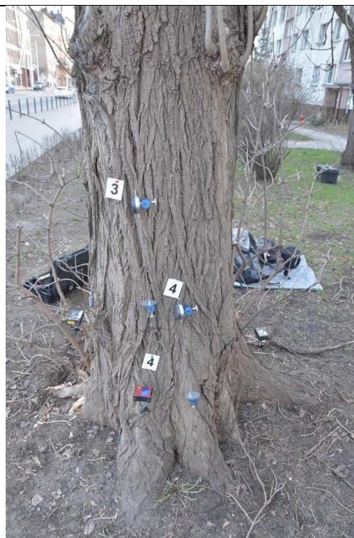
Fot. 6-10. Topola włoska ID 13881 ul. Hubska 41-53, Wrocław. Próba obciążeniowa - miejsce mocowania czujników – strona rozciągana
