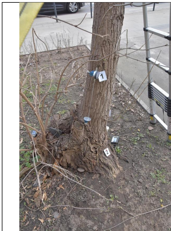
Fot. 5-6. Topola ID 13878, ul. Hubska 41-53, Wrocław. Próba obciążeniowa - miejsce mocowania czujników - strona ściskana
