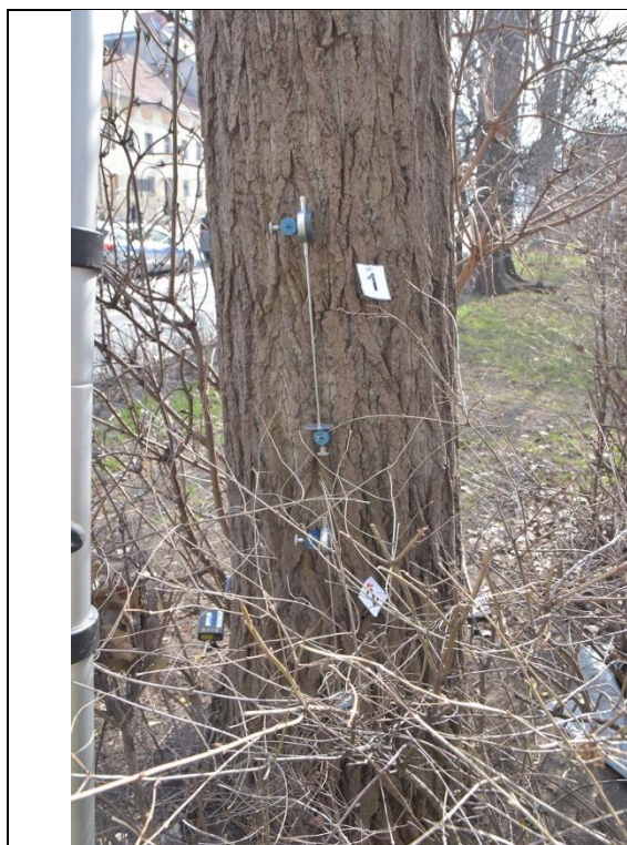
Fot. 4-7. Topola kanadyjska ID 13876, ul. Hubska 41-53, Wrocław. Próba obciążeniowa - miejsce mocowania czujników - strona ściskana
