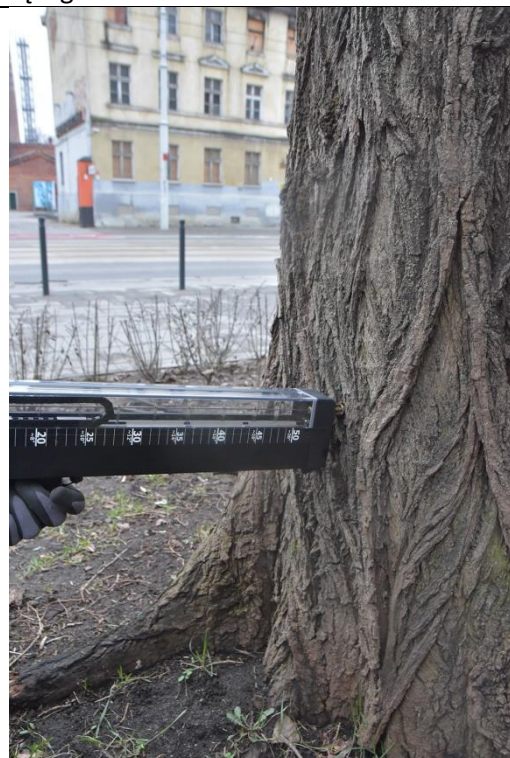
Fot. 3-7, 3-8. Topola włoska ID 13872, ul. Hubska 41-53, Wrocław.. Podczas badania rezystografem.
