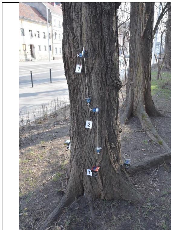
Fot. 3-9. Topola włoska ID 13872, ul. Hubska 41-53, Wrocław. Próba obciążeniowa - miejsce mocowania czujników - strona ściskana
