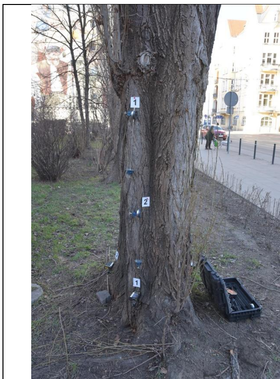
Fot. 7-8. Topola włoska ID 13883, ul. Hubska 41-53, Wrocław. Próba obciążeniowa - miejsce mocowania czujników - strona ściskana
