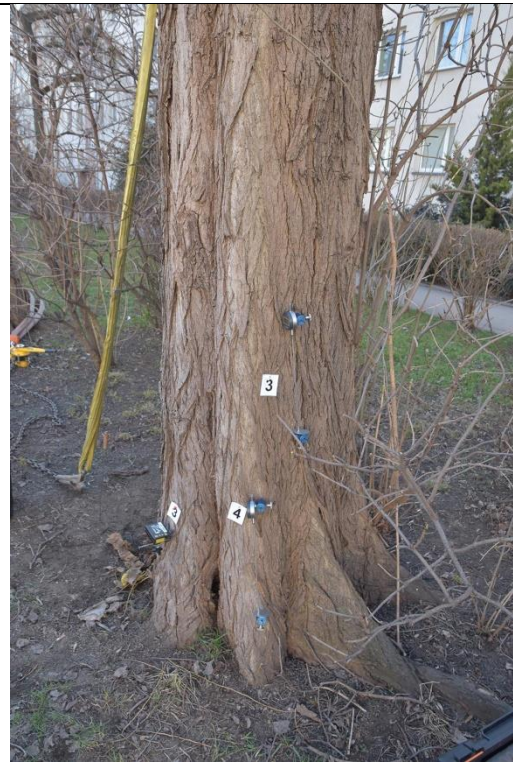
Fot. 9-8. Topola włoska ID 13885, ul. Hubska 41-53, Wrocław. Próba obciążeniowa - miejsce mocowania czujników – strona rozciągana
