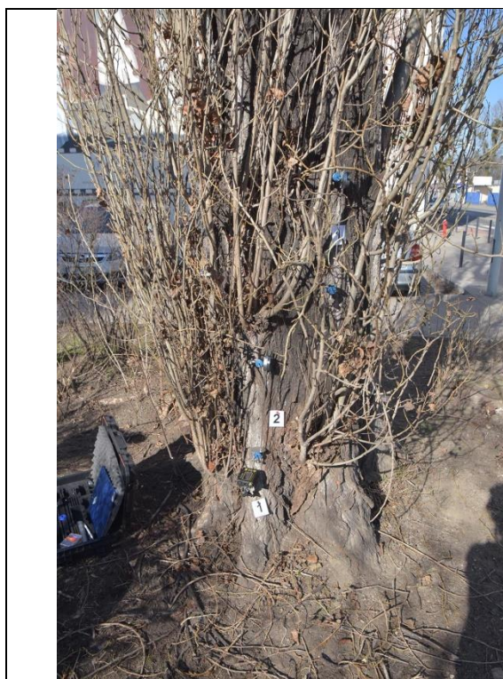
Fot. 10-8. Topola włoska ID 13889, ul. Hubska 41-53, Wrocław. Próba obciążeniowa - miejsce mocowania czujników - strona ściskana
